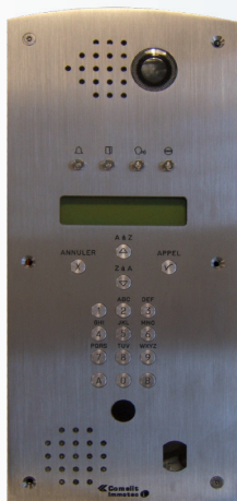
ART. PIC4/MH Platine digitale inox, module voix de synthèse avec LED de signalisation
